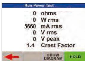
El nuevo diseño del banco de carga es capaz de medir la corriente hasta 6ª ARMS con un ciclo de trabajo máximo del 100% hasta por 60 segundos. Esto asegura que el Uni-Therm de Rigel sea compatible con todos los equipos de electrocirugía de alta potencia disponibles en el mercado.
